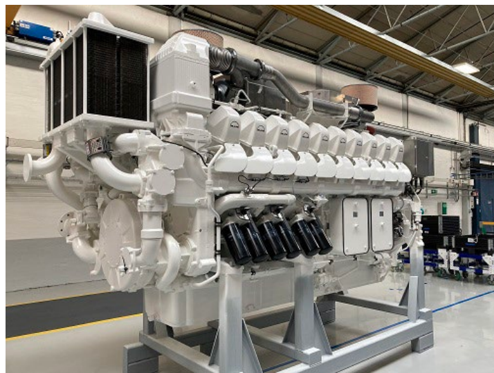
Bild des 20V175D-ML mit einer Leistung von 4.400 kW bei 2.000 U/min
