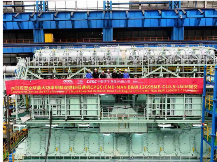
Bild von Der Werksabnahmeprüfung des neuen ME-LGIM bei CSSC-MES Diesel Co., Ltd. (CMD) in China
