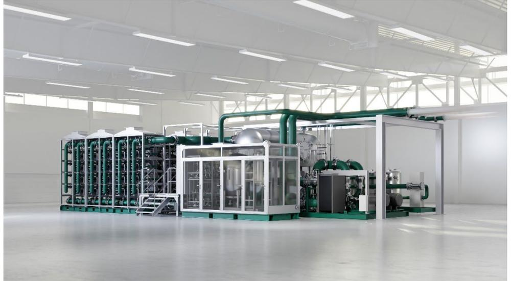
*Quest One hat den Bau einer Demonstrationsanlage seines PEM-Elektrolyseurs Modular Hydrogen Platform (MHP) auf dem Augsburger Werksgelände von MAN Energy Solutions gestartet (©Quest One)*
