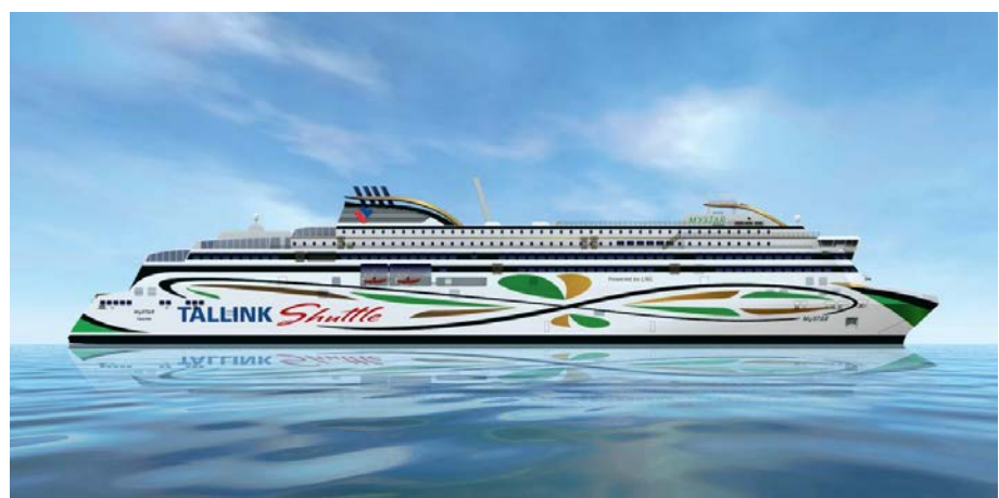
Grafische Darstellung der MySTAR, angetrieben von 5 Dual-Fuel-Hauptmotoren des Typs MAN 8L51/60DF (Bild: RMC)
