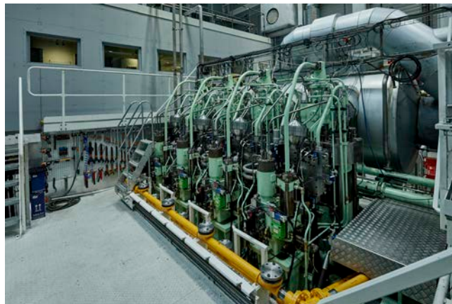
Versuchsmotor im Forschungszentrum Kopenhagen mit LGIP-Aufbau
