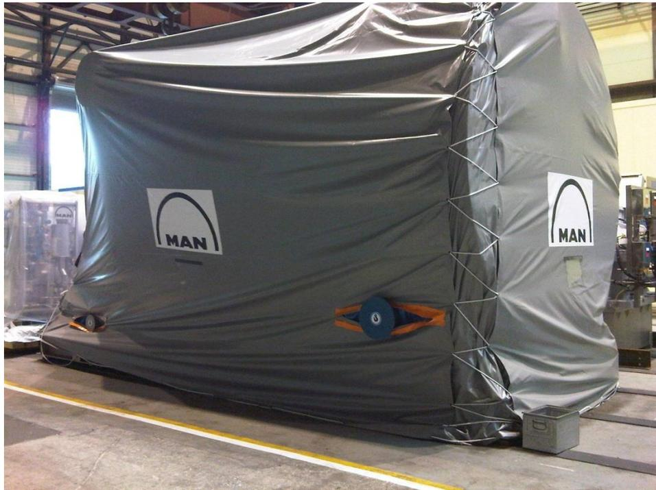
**Dampfturbine fertig verpackt für den LKW-Transport**
