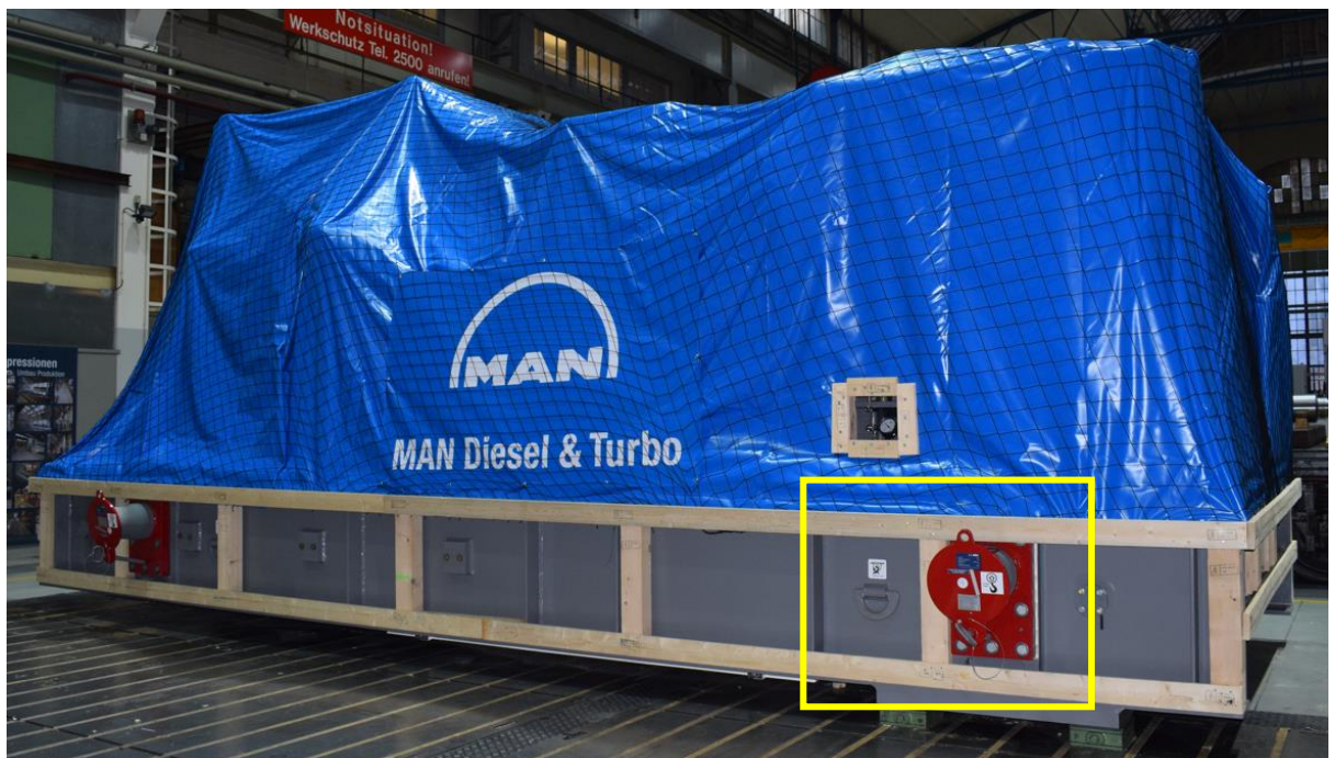
Abb. No. 029: Beispiel der Kennzeichnung am Kompressor-Skid
