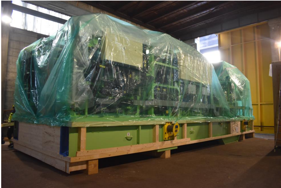
Abb. No. 008: Skid komplett mit VCI-Folie bedeckt
