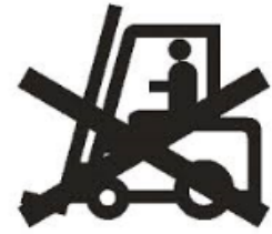
Gabelstapler hier nicht ansetzen Do not use fork lift truck here
