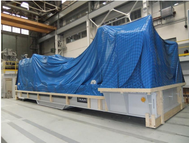
Abb. No. 007: Skid verpackt mit Blache und Netz
